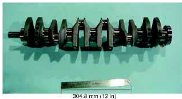
میل لنگ ماشین اسپورت tvr از جنس چدن نشکن آستمپر شده
